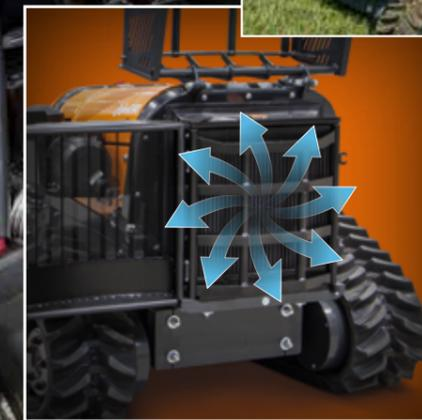
RoboEVO a été équipé d'un **ventilateur réversible hydraulique auto-nettoyante**, qui permet d'augmenter la productivité et d'économiser du carburant.
